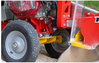
El **brazo de corte, montado sobre un pivote de torreta**, ofrece un movimiento de barrido del lado derecho/izquierdo de 85 cm. Este diseño permite un trabajo suave y ergonómico para el operador.
