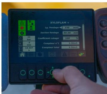
Für eine optimale Produktionskontrolle kann die Maschine optional mit dem **automatischen System XYLOMETER®** ausgestattet werden, Volumemessgerät XYLOMETER® zur Berechnung des Holzvolumens. - ein klarer Vorteil, um die gewünschte Menge genau zu produzieren.
