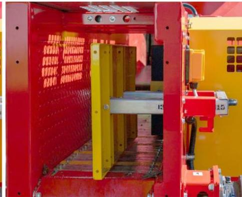
Die Spaltung erfolgt mit **Spaltkreuz**. Die **Spaltkraft von 16 Tonnen** garantiert eine konstante Effizienz, auch bei hartem oder knorrigem Holz.
