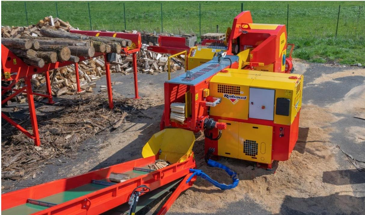
RABAUD erweitert sein Sortiment an Sägespaltautomaten mit der Einführung des **XYLOG 415**, einem **Hybridmodell**, das 2 anerkannte Maschinen kombiniert: die Sägeeinheit mit Kreissägeblatt des XYLOG 410 und das Spaltkreuz aus der XYLOFLAM 330/450, die seit 2016 auf dem Markt anerkannt ist.
