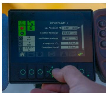
Pour un contrôle optimal de la production, la machine peut s'équiper en option du **système automatisé XYLOMETER®**, qui **calcule avec précision le volume de bois produit** – un atout incontournable pour produire la quantité souhaitée avec justesse.
