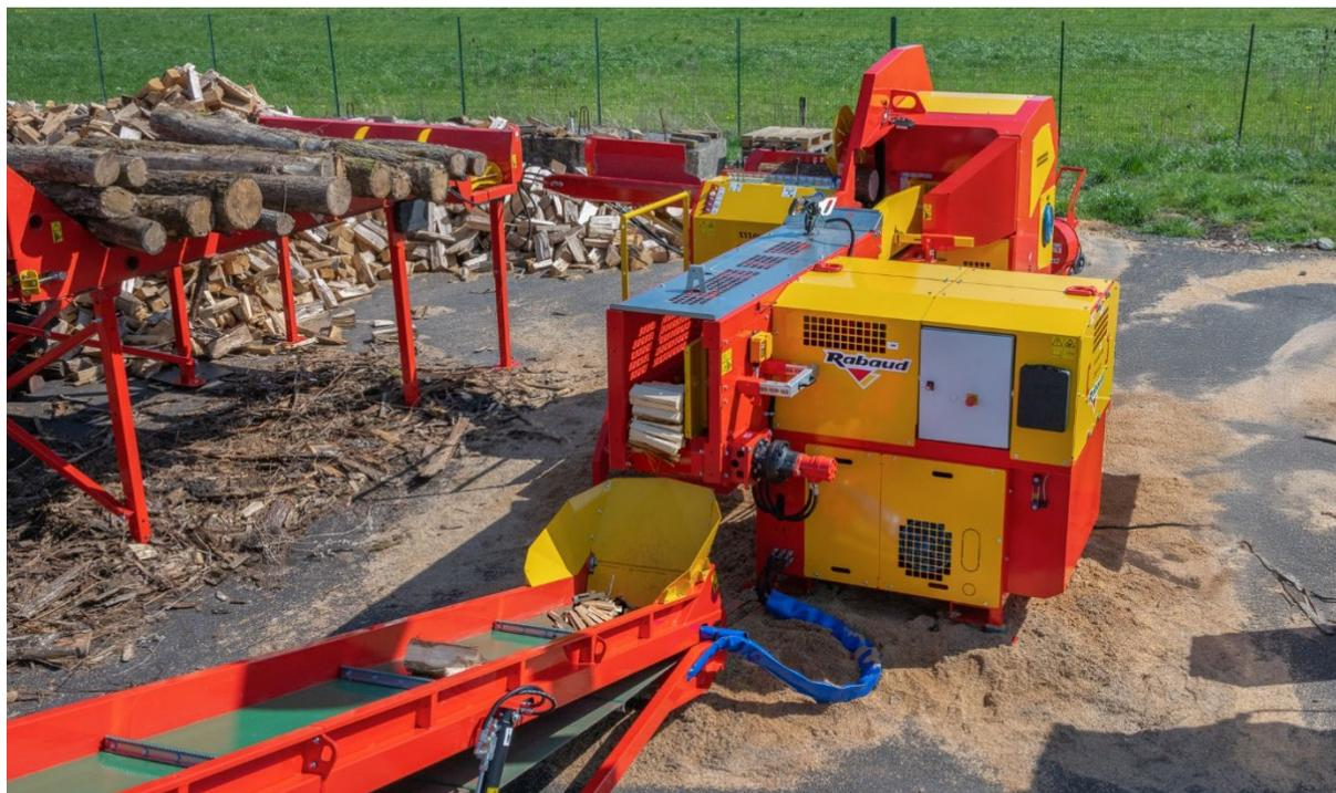
**RABAUD** enrichit sa gamme de combinés avec le lancement du **XYLOG 415**, un modèle **hybride** combinant 2 machines reconnues : l'unité de sciage par lame circulaire du XYLOG 410 et le module de fendage par couteaux croix issu de la XYLOFLAM 330/450, reconnue sur le marché depuis 2016.
