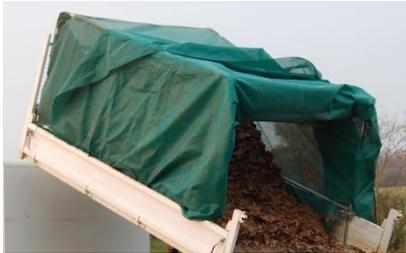
Um noch einen Schritt weiter zu gehen, kann ein **optionales Aufbausatz für Kipper** hinzugefügt werden, mit dem der Abfall im Anhänger eingeschlossen und so die Ladekapazität erhöht werden kann.
