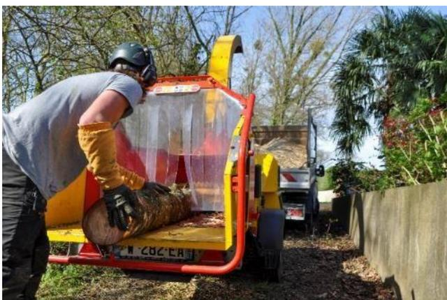
Dieser Motor verfügt über eine Drehmomentreserve, die es ermöglicht, bei Bedarf zusätzliche Leistung zu erbringen, ohne die Geschwindigkeit zu reduzieren oder das Risiko des Abwürgens einzugehen. Dies ist besonders beim Häckseln von großen Ästen oder sehr hartem Holz von Vorteil. Durch die Anpassung der Leistung wird der Häcksler schneller wieder hochgefahren, wenn die Nostress ausgelöst wird.
