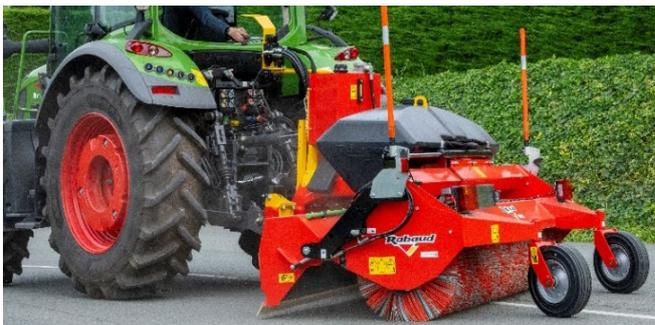
Grâce à son vérin hydraulique, l'ouverture du bac s'effectue facilement depuis la cabine via un distributeur ou à l'aide d'une radiocommande. Le système de vidage est simplifié, permettant ainsi de passer rapidement d'une fonction aligneuse à une fonction ramasseuse, augmentant ainsi sa polyvalence.
