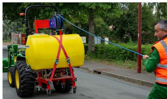
La puissance transmise par la prise de force (PDF) du tracteur permet de maintenir un **régime constant à pleine charge**. La pompe haute pression est ainsi exploitée à 100%.
