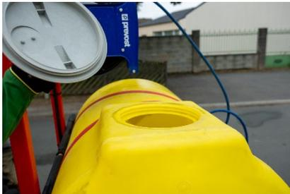
La cuve à eau de 600 litres en polyéthylène est conçue pour résister aux intempéries et à la corrosion. Sa large ouverture facilite le remplissage ainsi que l'entretien de la cuve.
