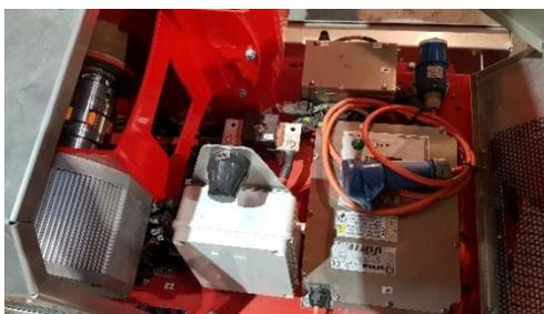
Der WINDY 491 E ist mit einem 5,5-kW-Elektromotor ausgestattet, der von **Lithium-Ionen-Batterien** gespeist wird. Er ist für die intensive Arbeit von professionellen Grünflächenpflegern ausgelegt. Er vereint die Vorteile des kabellosen Elektroantriebs mit der Kraft von Lithium-Ionen-Akkus.
