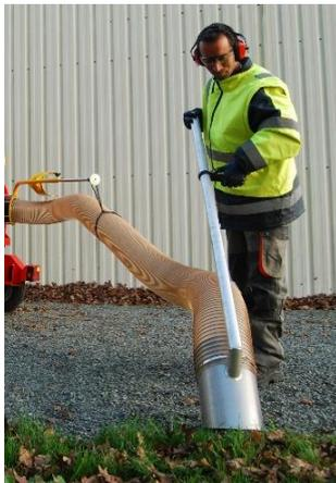
Wie seine Kollegen ist auch der WINDY 491 E mit einem **Saugrohr mit 200 mm Durchmesser, einem Handgriff und einem Schürfleistenrad** ausgestattet. Dies verringert die Ermüdung des Bedieners und bietet ihm zusätzlichen Komfort. Dieses Rohr ist exzentrisch zur Turbine positioniert, wodurch ein Verstopfen des Pflanzenmaterials vermieden wird.
