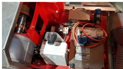
Équipé d'un moteur électrique 5,5 kW alimenté par **des batteries lithium-ion**, le WINDY 491 E est dimensionné pour le travail intensif des professionnels des espaces verts. Il allie les avantages de l'électrique sans fil à la puissance du lithium-ion.
