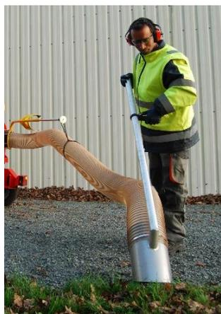
Comme ses homologues, le WINDY 491 E est équipé **d'un tuyau d'aspiration de 200 mm de diamètre, avec poignée et roue de terrage**. Ce qui réduit la fatigue de l'opérateur et lui procure un confort supplémentaire. Ce tuyau est positionné de manière excentrée par rapport à la turbine, évitant ainsi les bouchages de végétaux.
