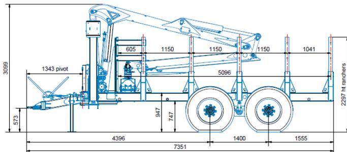
Der XYLOTRAIL 18 hat ein zulässiges Gesamtgewicht von **18 Tonnen** und ist für den Straßenverkehr mit einer Geschwindigkeit von 25 km/h zugelassen, dank seines hydraulischen Bremssystems an allen vier Rädern. Seine Wippachse ermöglicht einen wichtigen Federweg, was die Stabilität beim Fahren auf unebenem Gelände erheblich verbessert.
