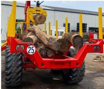
Der speziell für die hohen Anforderungen beim Verladen im Wald entwickelte Zweibalkenrahmen des XYLOTRAIL 18 integriert zwei Zentralbalken, die eine hohe Torsionsbeständigkeit gewährleisten. Zudem sind die 10 Rungen direkt am Rahmen verschweißt, was eine erhöhte Robustheit garantiert. Diese Rungen wurden umgeformt, um den Schwerpunkt des Anhängers zu senken und somit eine perfekte Stabilität und eine hohe Bodenfreiheit zu bieten.
