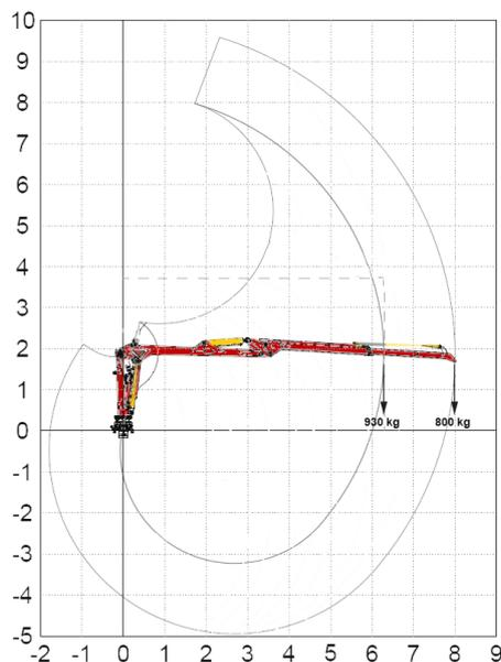
Das andere Hauptmerkmal des XYLOTRAIL 18 ist der neue XYLOGRUE 8 PRO Kran, der optional ausgerüstet ist. Dieser 8-Meter-Kran hat eine Hubkapazität von 800 kg am Auslegerende. Ausgestattet mit 4 Drehzylindern bietet er Flexibilität in der Nutzung. Die Steuerung des Krans kann nach den Vorlieben des Benutzers angepasst werden, wobei eine Auswahl zwischen Hirschgeweih-Multifunktionshebel, Joysticks oder einer Fernbedienung besteht.
