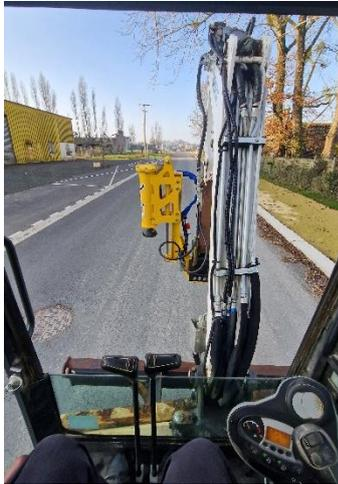
Der versetzte Hammer bietet von der Fahrerkabine aus eine **optimale Sicht** auf das Werkzeug, sodass der Pfahl während des Rammens eingestellt oder ausgerichtet werden kann.
