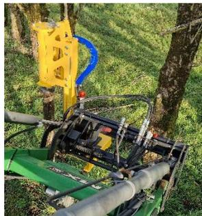
Son Die Anpassung an den Träger ist einfach, eine geschraubte Platte, auf der **RABAUD die Aufnahme Ihrer Wahl montieren kann**, ermöglicht den Anbau an jeder Marke von Ladern, Teleskopen oder Minibaggern. Je nach den am Trägergerät verfügbaren hydraulischen Anschlüssen kann der RABAUD-Service auch ein 6-Wege-Ventil sowie eine elektrische Verlängerung vorsehen.
