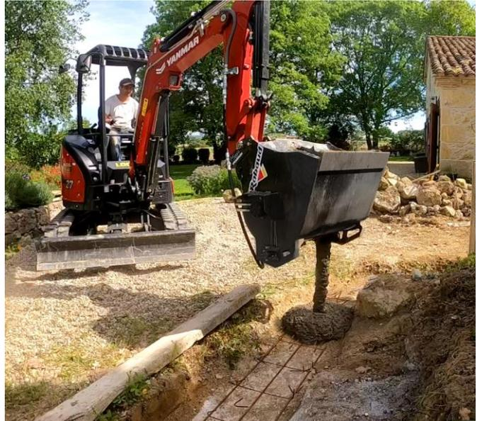
*Eine Betonmischschaufel mit speziell für Minibagger konzipierten Schaufelblättern !*
