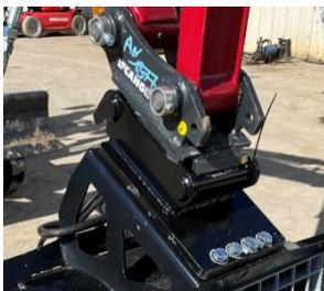
**Die Anpassung ist einfach und kann an jede Marke von Minibaggern** dank einer verschraubten Platte erfolgen, auf der RABAUD die automatische Kupplung Ihrer Wahl installieren kann.
