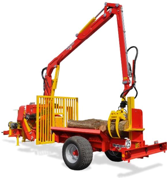
Der hydraulische Holzspalter F40, der für professionelle Brennholzhändler oder Bauer bestimmt ist, wird zum Modell **F45** weiterentwickelt, das eine Spaltkraft von 40 bis **45 Tonnen** hat.
