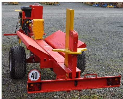
Die größere V-Form zentriert den Stamm gegenüber dem Spaltkeil. Die V-förmigen Ränder schützen die Räder bei der Version mit Straßenfahrgestell.
