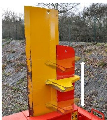
Bei diesem neuen Modell wurde das **Spaltkreuz weiterentwickelt**. Die beiden scharfen Messern, die ursprünglich kreuzförmig angeordnet waren, sind nun versetzt zueinander angeordnet. Diese **neue Konfiguration** ermöglicht eine **bessere Verteilung der Spaltkraft** für optimale Ergebnisse. Das Holz wird an der ersten Messer in zwei Teile gespalten, bevor es an der zweiten Messer horizontal gespalten wird.
