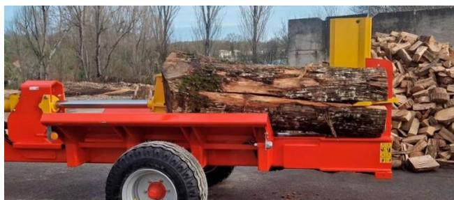
Der Hub des Zylinders ist einstellbar, um die Zykluszeit zwischen dem Auslösen des Spaltkreuzes und dem Beginn des Spaltvorgangs zu verkürzen.
