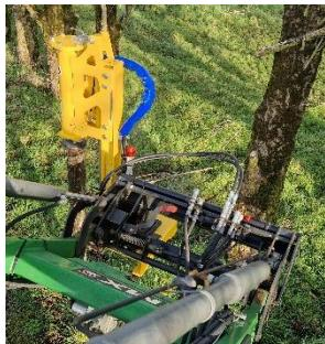
Son adaptation sur le porteur est simple et peut se faire sur n'importe quelle marque de chargeur, télescopique ou mini-pelle grâce à une platine boulonnée sur laquelle **RABAUD peut installer l'attache rapide de votre choix**. Également, selon les arrivées hydrauliques à disposition sur le porteur, les services RABAUD peuvent prévoir une vanne 6 voies ainsi qu'une rallonge électrique.
