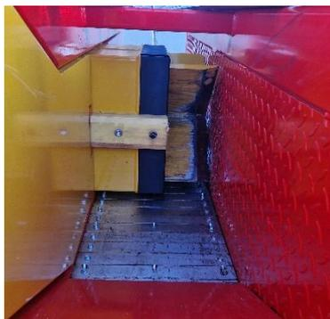
Die Funktionsweise des XYLOFLAM 330/450 + ist einfach und effizient: Nachdem das Holz in das Einzugskanal eingefüllt wurde, fällt es durch die Schwerkraft auf ein Einzugsband aus Stahl. Es wird dann zu einem Spaltkreuz mit einer Leistung von 16 Tonnen geleitet, das für eine gleichmäßige Spaltung sorgt und die Herstellung von Zündholz sowie von Scheitholz ermöglicht.
