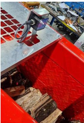
Außerdem ist die Option XYLOMETER erhältlich. Dieses Gerät misst das Volumen des produzierten Holzes und bietet so eine zusätzliche und genaue Kontrolle über den Produktionsprozess.
