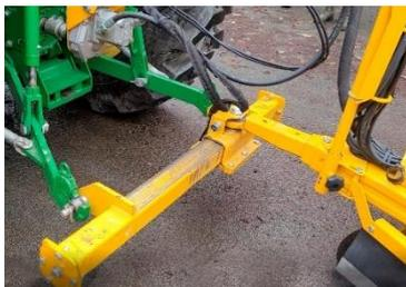
Diese neue gezogene Kehrmaschine bleibt ihrem Manövrierfähigkeit treu und behält ihre einstellbare Zugdeichsel bei. Als Option ist nun eine hydraulische Anhängerkupplung, die um 500 mm seitlich versetzbar ist (250 mm rechts / 250 mm links). Mithilfe eines Zylinders lässt sich die Maschine von rechts nach links über die Spurweite des Traktors hinaus verschieben.
