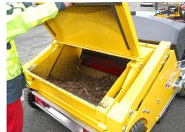
Der Sammelbehälter ist an hydraulischen Hubarmen montiert, mit denen er bis zu 2,10 Meter hoch gehoben werden kann, um ihn direkt in einen Container zu entleeren.
