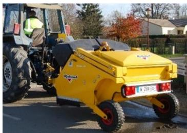
Der URBANET G ist mit einem zentralen Mischbesen aus Polypropylen und Polyester ausgestattet und garantiert eine optimale Reinigung ohne Beschädigung von Markierungen und Belägen. Ein effizientes Werkzeug sowohl auf Asphalt als auch auf Sportplätzen mit speziellen Belägen.
