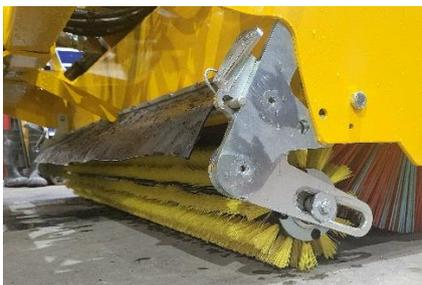
Die wichtigste Neuerung dieser Version ist die Integration eines Sammelbesens mit 165 mm Durchmesser, der den Appetit des URBANET G noch steigert. Dieses patentierte System ermöglicht es, sowohl leichte als auch sperrige Abfälle (Kieselsteine, Dosen, Flaschen usw.) effizient zu sammeln und Blätter, Sand, Erde usw. zu entfernen. Diese Abfälle werden dann zum mittleren Besen gezogen, der sie in den Sammelbehälter schleudert.
