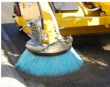
Der optionale schwebende Seitenbesen ermöglicht die Anpassung an schwer zugängliche Bereiche ohne Einstellung! Mögliche Ausstattung auch mit Stahlbürste oder Stahllamellen für eine mechanische Wildkrautbeseitigung.
