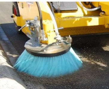
L'option balai latéral flottant, permettant de s'adapter aux zones plus difficiles d'accès sans réglage ! Un avantage pouvant s'équiper de fibres en acier, notamment pour des travaux de désherbage mécanique dans les communes.
