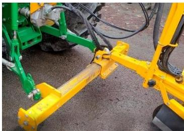
Toujours fidèle à son critère de maniabilité, cette nouvelle balayeuse trainée conserve son timon réglable **et propose désormais, en option, un attelage hydraulique déportable latéralement de 500mm** (250 mm à droite / 250 mm à gauche). Grâce à un vérin, la machine se déporte de droite à gauche au-delà du gabarit du tracteur garantissant un nettoyage optimal le long des bordures, trottoirs, caniveaux, pistes cyclables...
