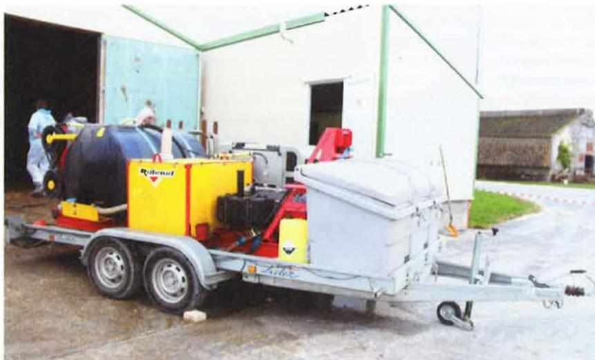
Le groupe haute pression est monté sur remorque et reste à l'extérieur du bâtiment. Il est alimenté par un moteur diesel de 140 bars avec une cuve tampon de 1000 litres et une pompe doseuse pour le détergent moussant.
