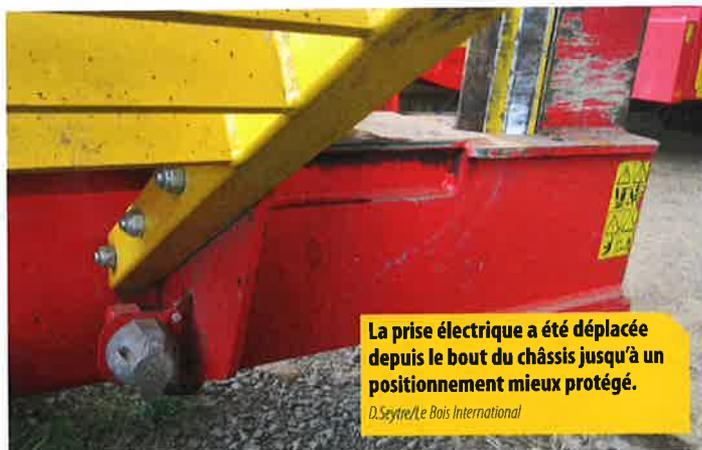
**La prise électrique a été déplacée depuis le bout du châssis jusqu'à un positionnement mieux protégé.**
