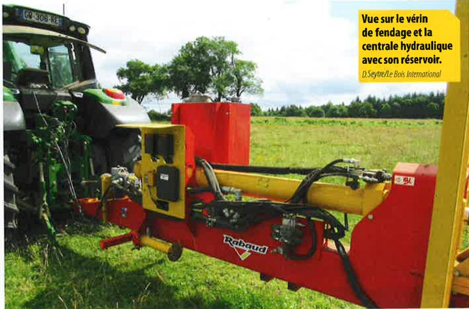
**Vue sur le vérin de fendage et la centrale hydraulique avec son réservoir.**
