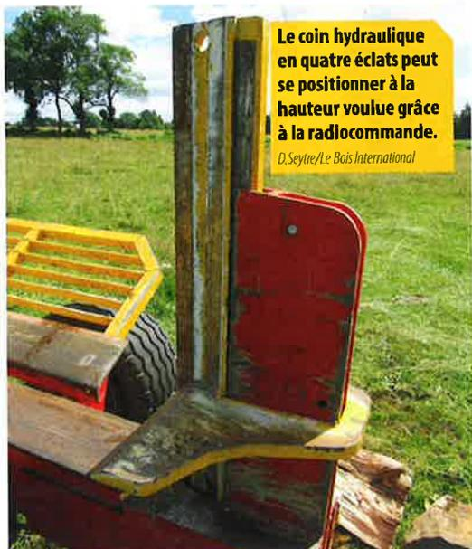
**Le coin hydraulique en quatre éclats peut se positionner à la hauteur voulue grâce à la radiocommande.**
