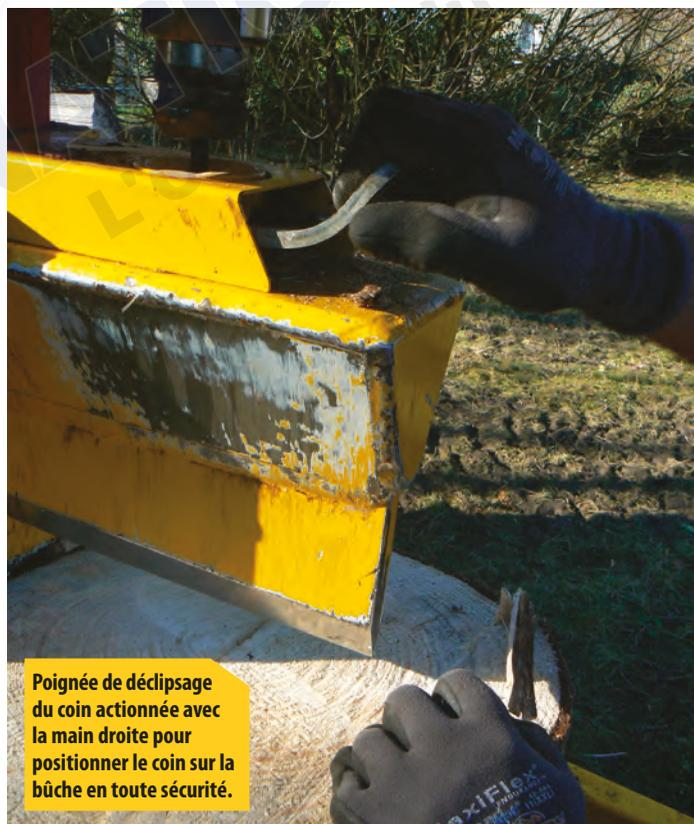
Poignée de déclipsage du coin actionnée avec la main droite pour positionner le coin sur la bûche en toute sécurité.
