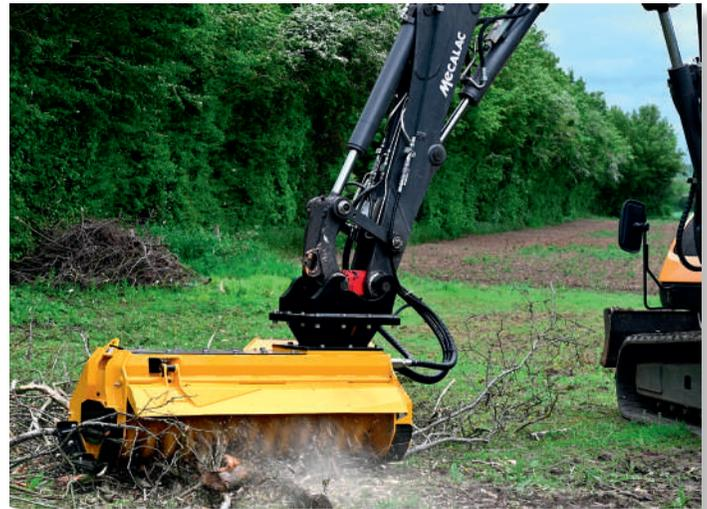
**Les broyeurs forestiers hydrauliques Xylor PE fonctionnent à l'aide de moteurs hydrauliques à pistons.** Rabaud SAS
