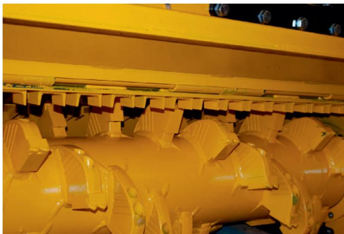
Les deux broyeurs Rabaud Xylor PE sont équipés d'un rotor hélicoïdal avec équilibrage électronique. Rabaud SAS
